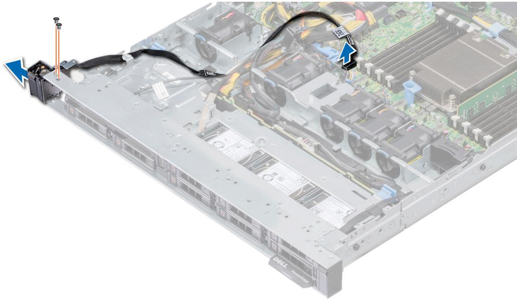
**Ilustración 91. Extracción del panel de control izquierdo**
