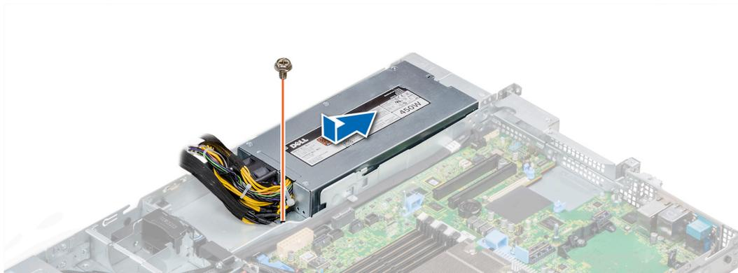
**Ilustración 88. Instalación de una PSU cableada**
