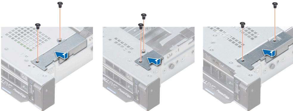
**Ilustración 96. Instalación de la cubierta de cables**
