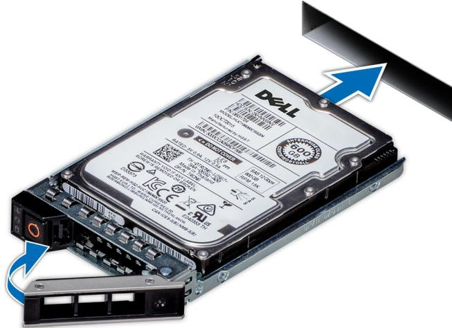
**Ilustración 38. Instalación de una portadora de unidades**
