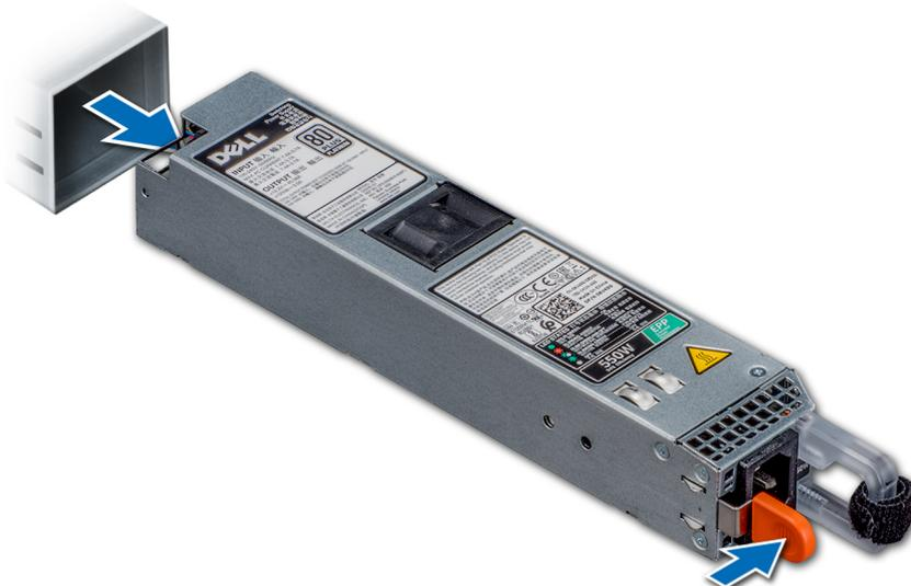
Ilustración 85. Extracción de una unidad de fuente de alimentación
