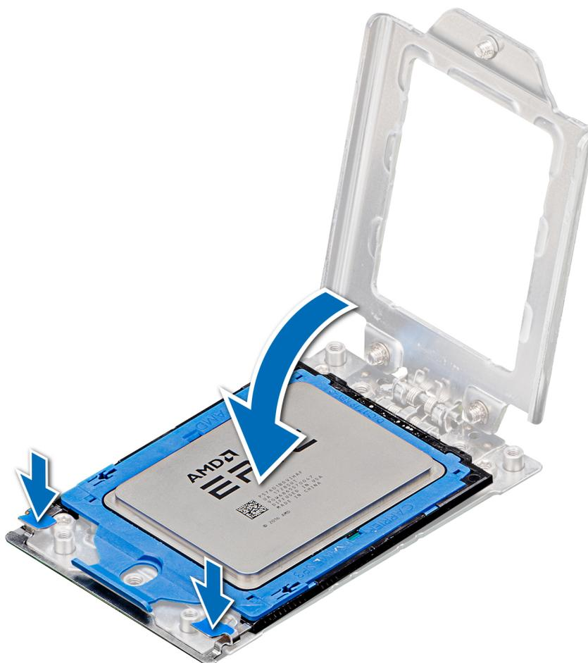
**Ilustración 49. Cierre del marco del socket del procesador**
