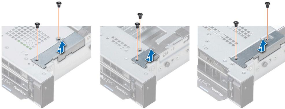
**Ilustración 93. Extracción de la cubierta de cables**
