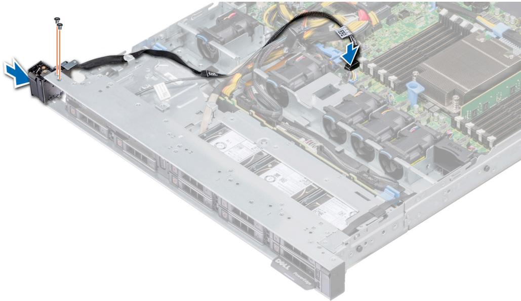
**Ilustración 92. Instalación del panel de control izquierdo**
