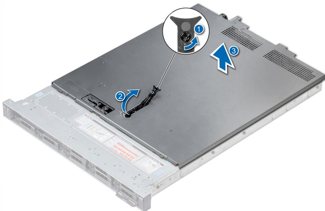
Ilustración 24. Extracción de la cubierta del sistema
