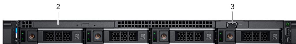
**Ilustración 3. Vista frontal del sistema de unidades de 4 x 3,5 pulgadas**
