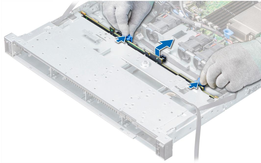
**Ilustración 73. Extracción del plano posterior**
